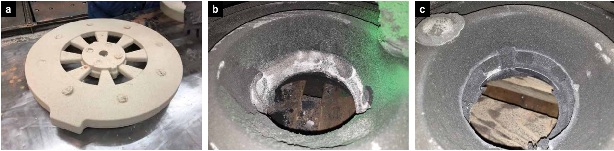
Bild 4: a) Kern für Bremsscheibe, ca. 15 kg, b) gegossene Bremsscheibe aus Gusseisen, anorganischer Kern, Sandanhaftungen, c) gegossene Bremsscheibe aus Gusseisen, PUR-Cold-Box-Kern.
