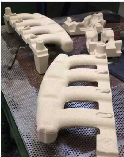
Bild 8: Anorganisch gebundene Ansaugkrümmerkerne für den Nichteisenguss.
