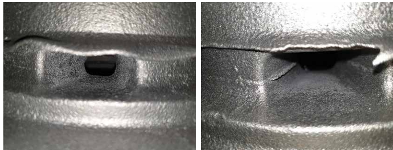
Bild 5: Gussteil aus Bild 4 nach dem Strahlen: a) anorganischer Kern ohne Blattrippe, b) PUR-Cold-Box-Kern mit Blattrippe.
