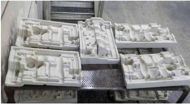
Bild 7: Anorganisch gebundene Kernpaketkerne für den Eisenguss.
