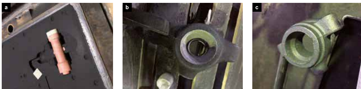
Bild 7: Anorganisch gebundener Kern (a) sowie Eisengussteil vor (b) und nach dem Strahlen (c).
