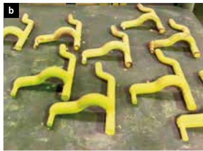
Bild 9: Anorganisch gebundener Kern aus Bauxitsand vor (a) und nach (b) dem Schlichten. Blatttrippenbildung am Gussteil bei Nutzung des PUR-Cold-Box-Verfahrens (c).
