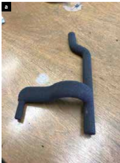
Bild 9: Anorganisch gebundener Kern aus Bauxitsand vor (a) und nach (b) dem Schlichten. Blatttrippenbildung am Gussteil bei Nutzung des PUR-Cold-Box-Verfahrens (c).
