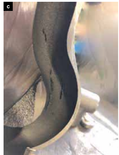
Bild 9: Anorganisch gebundener Kern aus Bauxitsand vor (a) und nach (b) dem Schlichten. Blatttrippenbildung am Gussteil bei Nutzung des PUR-Cold-Box-Verfahrens (c).
