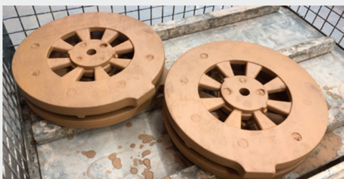
Abb.: Anorganisch gebundene Kerne 2 % Binder, Masse ca. 6 kg, geschichtet
